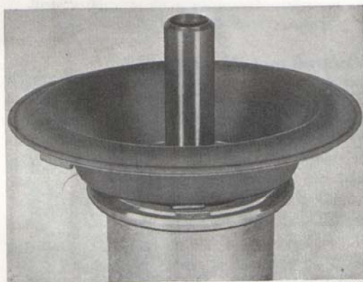
Bild 103. Membran i vakuumkolv
