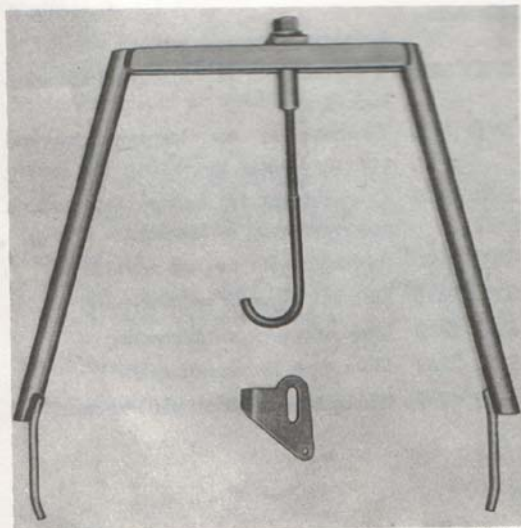
Bild 3. Lyftbygel SVO 2727 används vid demontering av oljesump. 140-serien
