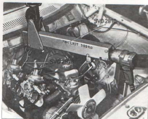
Bild 13. Uryftning av motor
