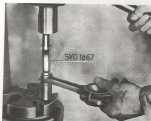
Bild 35. Byte av bussning, vevstake
