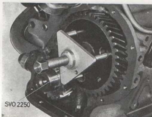
Bild 45. Demontering av kamaxeldrev
