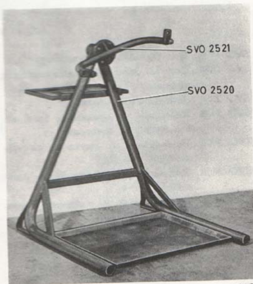
Bild 5. Stativ SVO 2520 och fixtur SVO 2521, för motor
