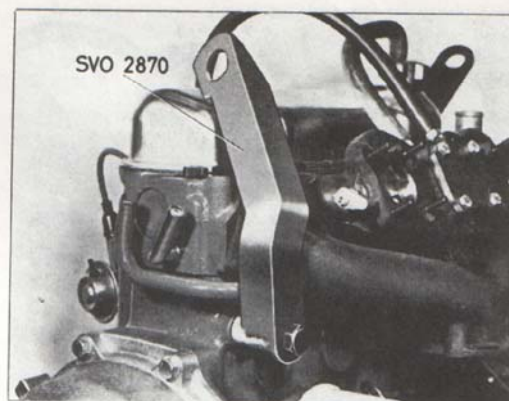
Bild 14. Montering av lyftöra i bakre ände
