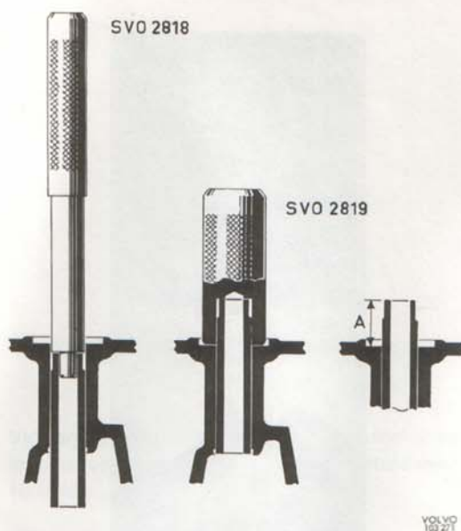
Bild 28. Byte av ventilstyrningar
